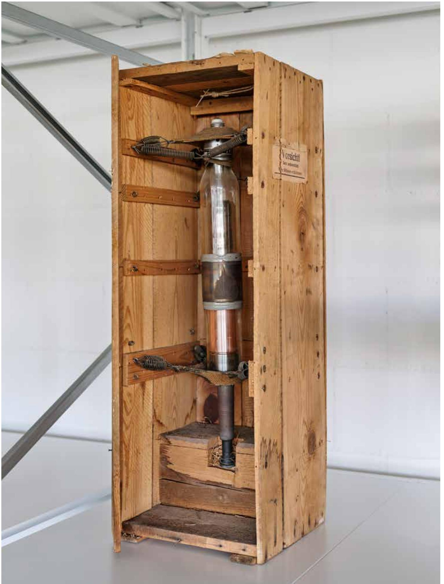
Die Röntgenröhre Rotalix (um 1929) ermöglichte kürzere Belichtungszeiten und schärfere Aufnahmen sich bewegender Organe.
