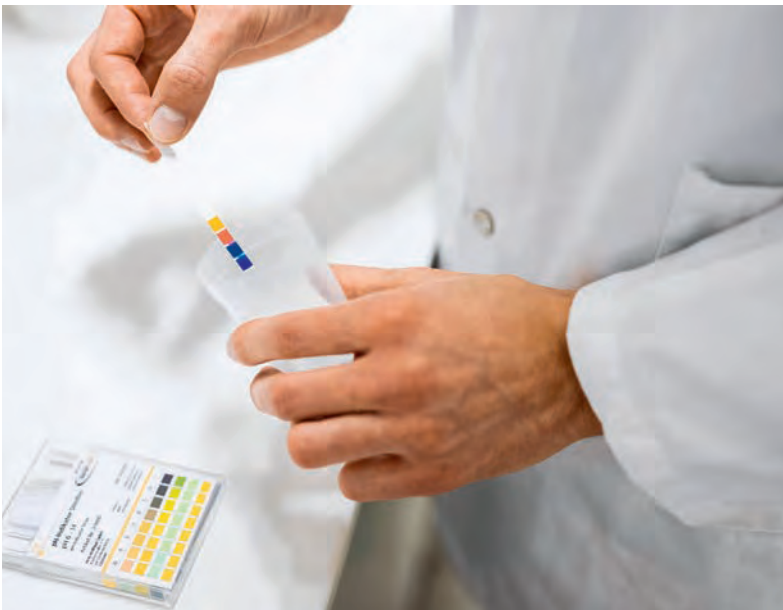
Bild oben: Petrischalen mit Nährmedien, auf dem Deckel der 1LIMS-QR-Code zur Identifizierung der Probe. Bild Mitte: Die Bestimmung der Trübung im Reagenzglas. Bild unten: Der pH-Wert wird mit einem pH-Indikator-Streifen ermittelt.
